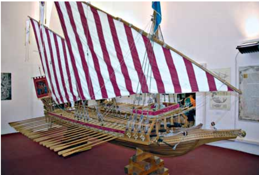
La fedele riproduzione della galea con la quale il principe Marcantonio Colonna combatté a Lepanto; da prora sono visibili lo sperone, la palmetta, la batteria di bordo sovrastata dalla remba, i banchi dei rematori, le due vele latine e, a poppa, lo stendardo del comandante
